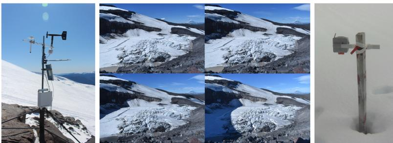
Figure 2: Estaciones meteorológicas automáticas, cámara secuencial, arduinos
