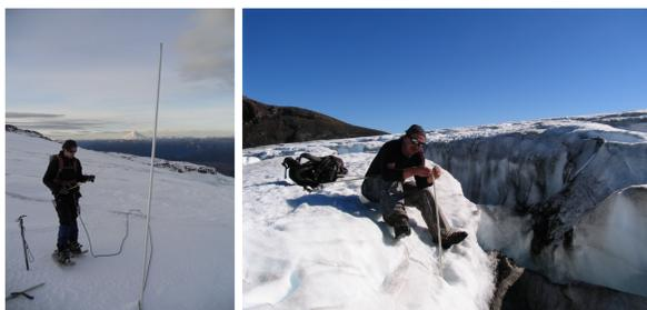
Figure 3: baliza de acumulación (izquierda) y baliza de ablación (derecha)
